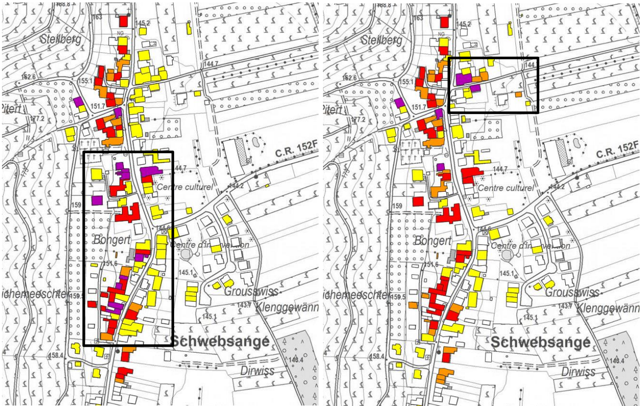
Abbildung 90: Gefährdung der Gebäude in Schwebsänge bei T = 100 a, ohne Maßnahmen (links) und mit Maßnahmen (rechts)
