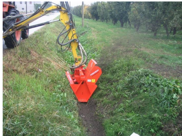
Abbildung 59: Schlechtes Beispiel Graben ist viel zu schmal, https://www.cosmecosl.com → Grabenfräse
